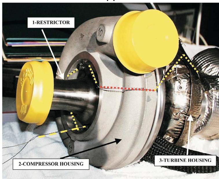
Restruktoram jābūt izgatavotam no viendabīga materiāla un to jāpārdz caururbt tikai montāžai un plombešanai, kas jāveic starp montešanas skrūvē, starp restriktoru (vai restriktora/kompresora korpusa stiprinājumiem), kompresora korpusu (vai korpusa/atloka stiprinājumu) un turbīnas korpusu (vai korpusa/atloka stiprinājumu) skatīt zīmējumu.
